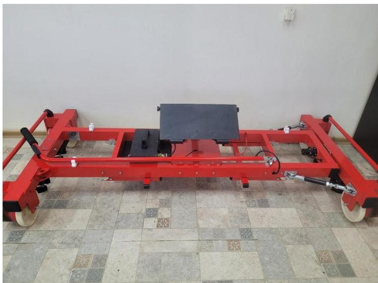
Виброизмерительная установка «АКСИОМА» - предназначена для измерений среднеквадратического значения виброускорения по трём взаимно ортогональным осям X, Y, Z и накопления измерительной информации в съёмной карте памяти с целью дальнейшей обработки, анализа и хранения.
