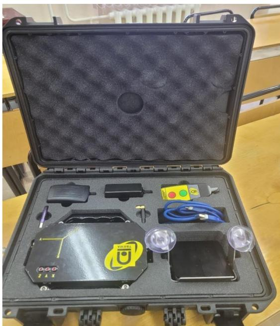
Дефектоскоп АВ-31 - предназначен для измерений координат выявленных дефектов, стрелочных переводов в обеих нитях железнодорожного пути, расшифровке дефектограмм, а также ручного контроля отдельных сечений и сварных стыков.
